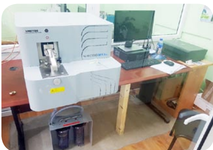
ХБНГУ-ын АМАТЕК компанид үйлдвэрлэсэн металын химийн шинжилгээ хийдэг спектрометр SPECTROMAXx M маркийн багаж
